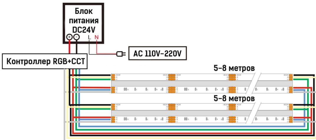
**ПРИМЕЧАНИЕ:** Обратитесь к схеме подключения для установки. Неправильное подключение может привести к короткому замыканию!
